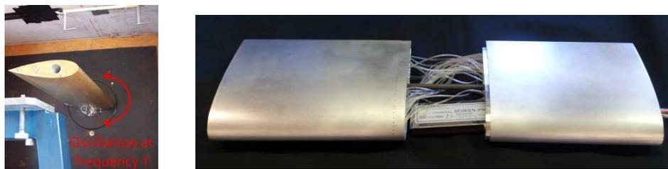
Figure 2: Mesure de décrochage dynamique dans la soufflerie à retour de l'IMSIA (gauche), et profil d'aile avec scanner de pression 32 voies embarqué (droite).
