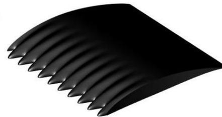
Ondulations de bord d'attaque sur profils
